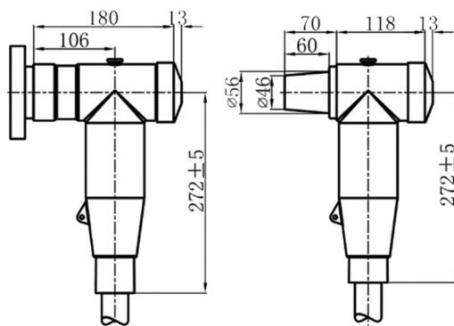
بوشینگ مورد استفاده در عایق (Air) B630AE1
